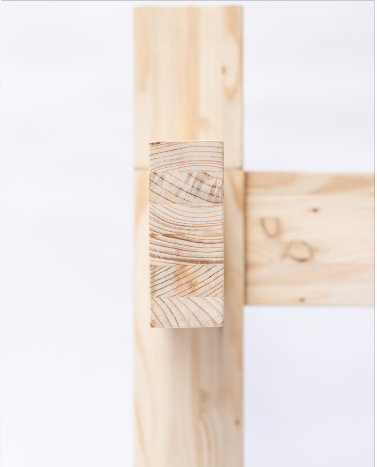
End grain showing lamellas.
